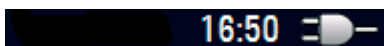
Fig.: R&S ZVH wird über das Netzteil versorgt und Akku ist voll geladen
